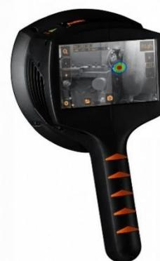
**Преимущества:** определяет объём утечки, выявляет утечки газов с расстояния, применим для любых газов, обнаруживает всасывание газа.
