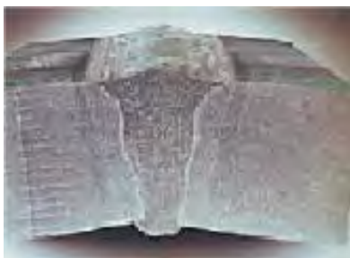
Рис. 4. Сварка в один проход металла толщиной 15 мм
