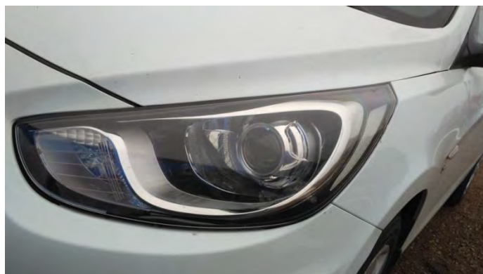
Рис. 4. Внешний вид фары с BI-LED модулем
