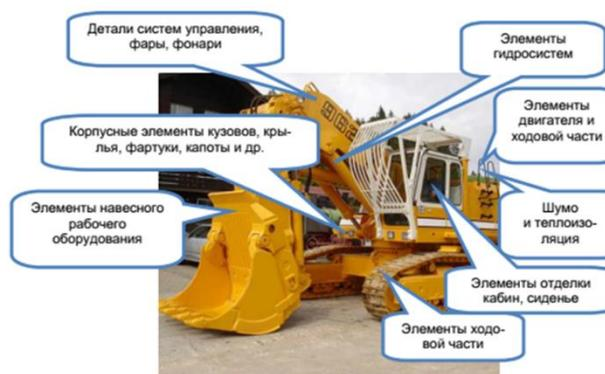
Рис. 18. Основные области применения ПКМ при производстве и ремонте дорожно-строительных машин
