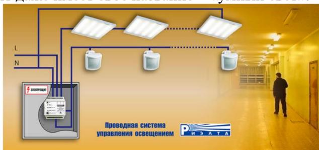
В наших подъездах уже сейчас устанавливаются лампы, включающиеся при хлопке или движении человека. Основу таких систем составляют диммеры и умные лампы, работающие вместе с датчиками измерения освещенности и присутствия живого объекта.
